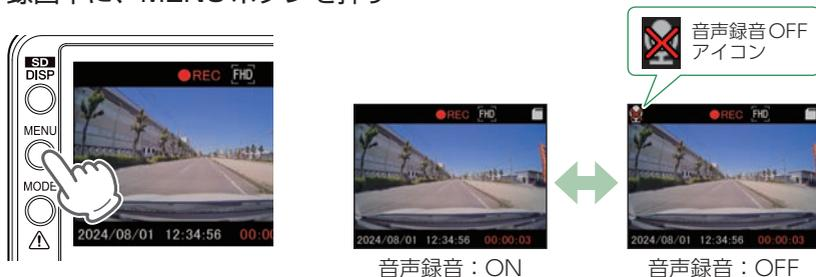
MENU ボタンを押すたびに、音声録音のON/OFFが変更できます。
