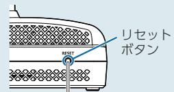
動作しなくなったり、誤作動を起こしたときは、本体下部のリセットボタンを押して、システムを再起動させてください。
