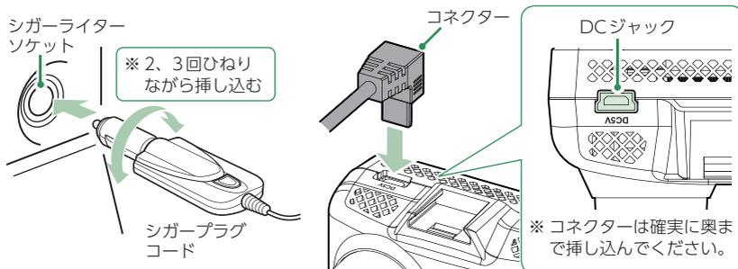
付属のシガープラグコードを本体のDCジャックと車両のシガーライターソケットに挿し込みます。
