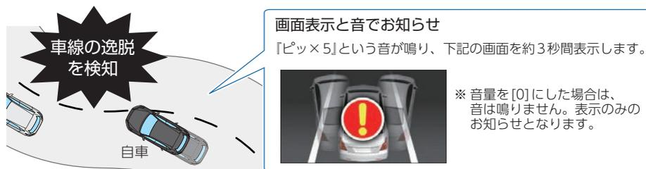
・画像処理によって車線を検知するため、紛らわしいシルエットを誤認識したり、車線の種類、車線幅や周囲の状況、気象条件等によって、正常に機能しない場合があります。あらかじめご了承ください。
