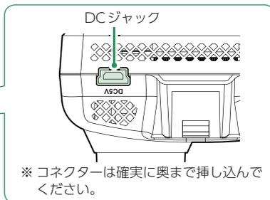
別売品の12V/24V対応電源直結コード(OP-E1160)を本体のDCジャックへ接続します。
