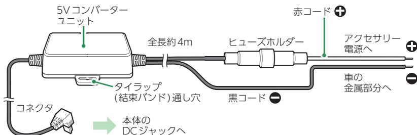
別売品の電源直結コードを本体のDCジャックと車両へ接続します。
