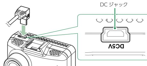
別売品の電源直結コード(OP-E863)を本体のDCジャックへ接続します。
