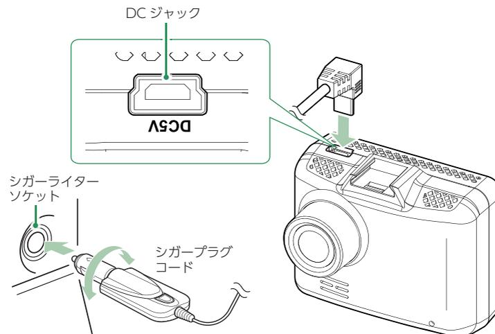
付属のシガープラグコードを本体の DC ジャックと車両のシガーライターソケットに差し込みます。
