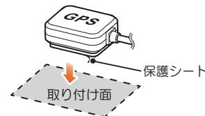
※ ダッシュボードの取り付け面の汚れ・脂分をよく落とし、慎重に取り付けてください。
