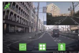
メインカメラとサブカメラの映像を同時に表示します。サブカメラの映像は右上に小さく表示します。
