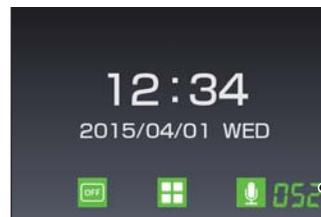
現在の日時を表示します。日時は、GPS 情報から取得します。右下には、現在の速度を表示します。※ 24 時間表示です。
