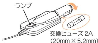
ヒューズを交換したあとは、シガープラグの先端を図の矢印と逆方向に回し、しっかりと締める
