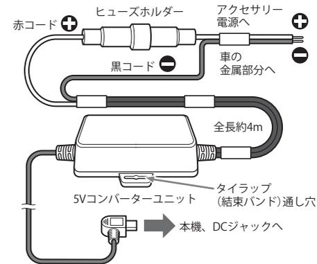
※ 作業中のショート事故防止のため、車両へ接続するときは、車のバッテリーのマイナス端子を必ずはずしてから作業してください。
