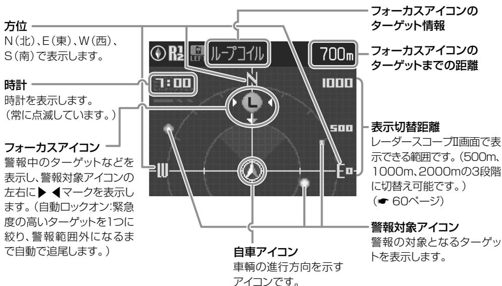
※ フォーカスアイコンのターゲットがループコイル、LHシステム、Hシステム、レーダー式オービス、取締りエリア、検問エリア、Nシステム、交通監視システムの場合は、設置されている方向を矢印で表示します。
