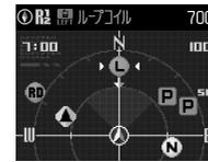
ターゲットが表示切替え距離の設定距離内に入ると自動で切替え
