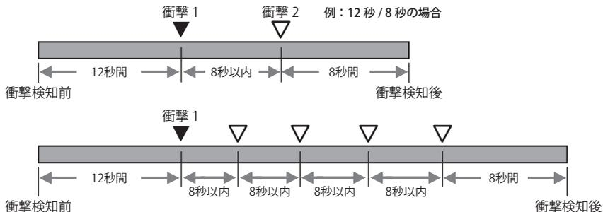
※ マルチトリガー検知後は、設定されている時間(例：8秒間)記録します。
