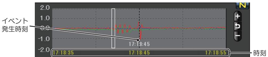
加速度センサースケールは、記録したデータを加速度(縦軸)と時間(横軸)でグラフ表示します。
