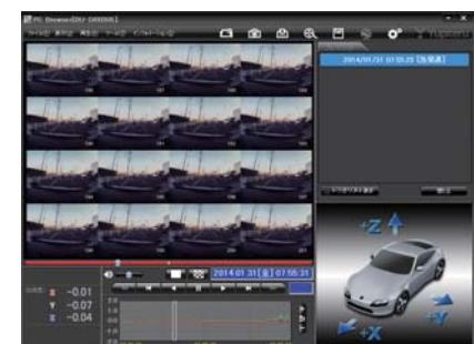
加速度センサーグラフは、記録したデータを加速度(縦軸)と時間(横軸)でグラフ表示します。
