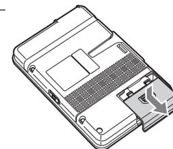
2 リチウムイオン電池の金属部が本体の電極に合うように取り付ける
