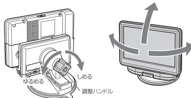
吸着盤ベースとクレードルが接触すると、振動でノイズが発生する場合があります。その場合はOP-CR50Ⅱに付属のクッションをクレードルの下部に貼り付けてください。
