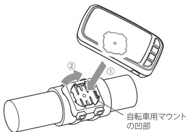
イラストは本機を縦方向に取り付ける場合のもので、横方向に取り付ける場合は、90度方向を変えて取り付けてください。
