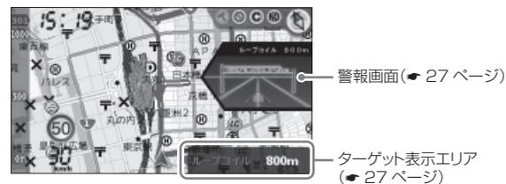
・目的地を設定しているときは、ターゲット表示エリアにタッチすると、住所・施設名・目的地までの直線距離の表示(住所・施設名・距離表示エリア)に切り替わります。(☛ 28ページ)
